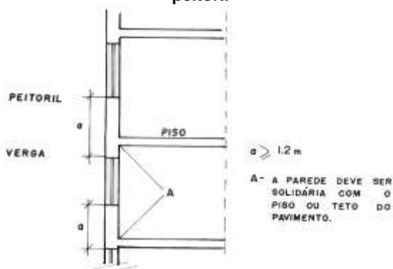
Figura 35 - Isolamento por aba horizontal ou balcão
