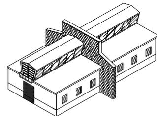
Com a previsão das paredes corta-fogo, uma edificação é considerada totalmente estanque em relação à edificação contígua.
