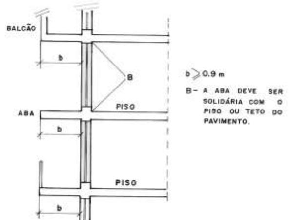
Figura 36 - Isolamento vertical de aberturas em laje
