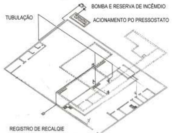
O Corpo de Bombeiros, em sua intervenção a um incêndio, pode utilizar a rede hidrantes (principalmente nos casos de edifícios altos). Para que isto ocorra, os hidrantes devem ser instalados em todos os andares, em local protegido dos efeitos do incêndio, nas proximidades das escadas de segurança.
