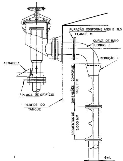
Figura 67 – Sistema semi-fixo
