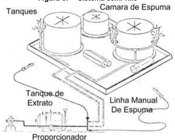
b) Semifixos, que são equipamentos destinados à proteção de tanque de armazenamento de combustível, cujos componentes, permanentemente fixos, são complementados por equipamentos móveis para sua operação. São, normalmente, móveis o reservatório de extrato e o conjunto dosador (proporcionador).
