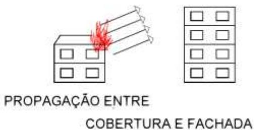
Figura 3 - Propagação entre cobertura e fachada.
