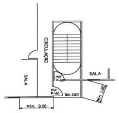
Figura 12 – Escada enclausurada do tipo PF ventilada por balcão
